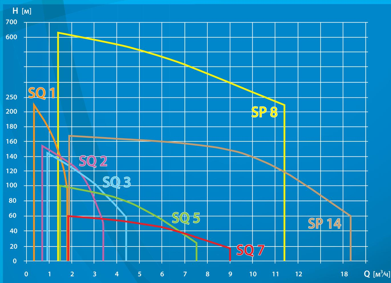
\*В данной брошюре представлена лишь часть модельного ряда насосов SP. Grundfos производит скважинные насосы серии SP, обеспечивающие подачу до 470 м³/час и напор до 670 м. Подробную информацию смотрите в каталоге «Скважинные насосы Grundfos».
